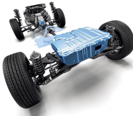
(hình ảnh chỉ mang tính minh họa, thông số kĩ thuật có thể thay đổi tùy theo từng thị trường) Hệ truyền động trên Subaru Crosstrek e-Boxer hybrid
