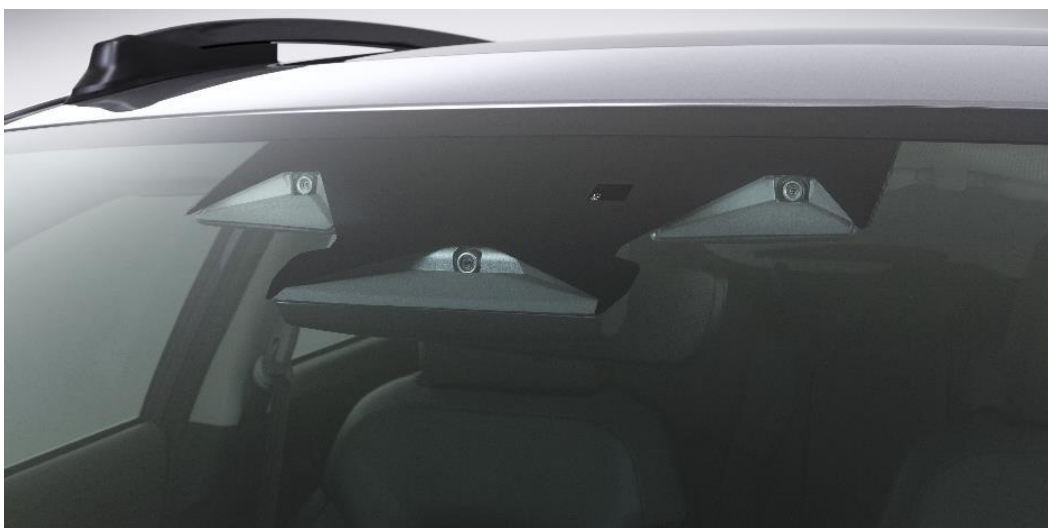
(Hình ảnh chỉ mang tính minh họa) EyeSight 4.0 cải tiến với camera đơn góc quét rộng và bộ stereo camera nâng cấp
